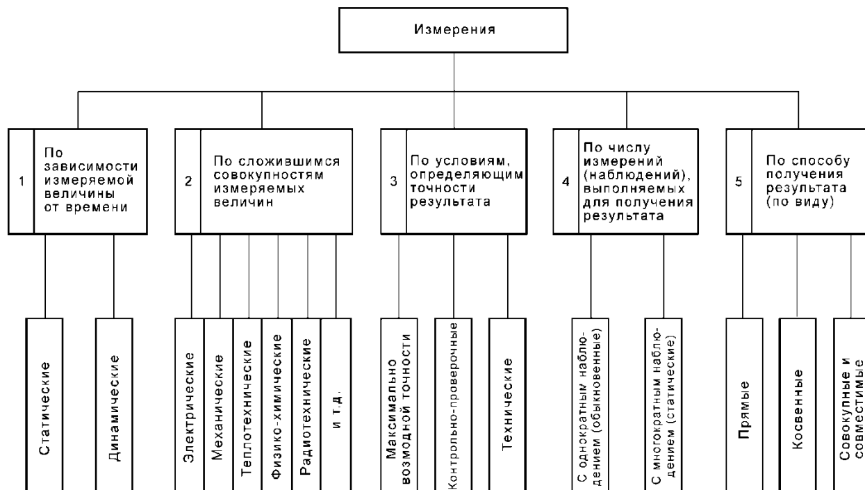
Рисунок 1 – Классификация средств измерения
