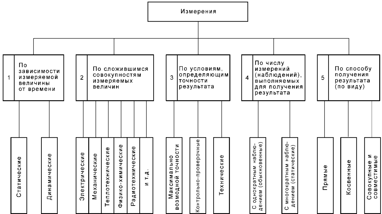
Рисунок 1 – Классификация средств измерения
