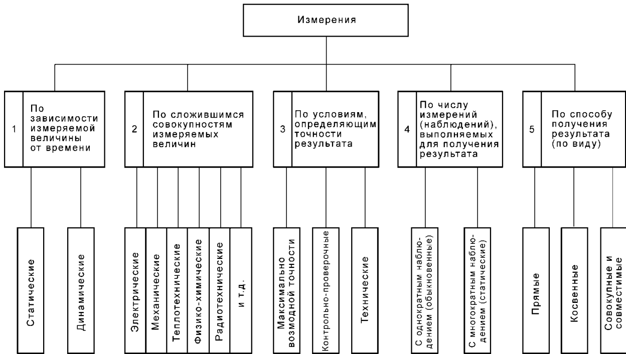
Рисунок 1 – Классификация средств измерения
