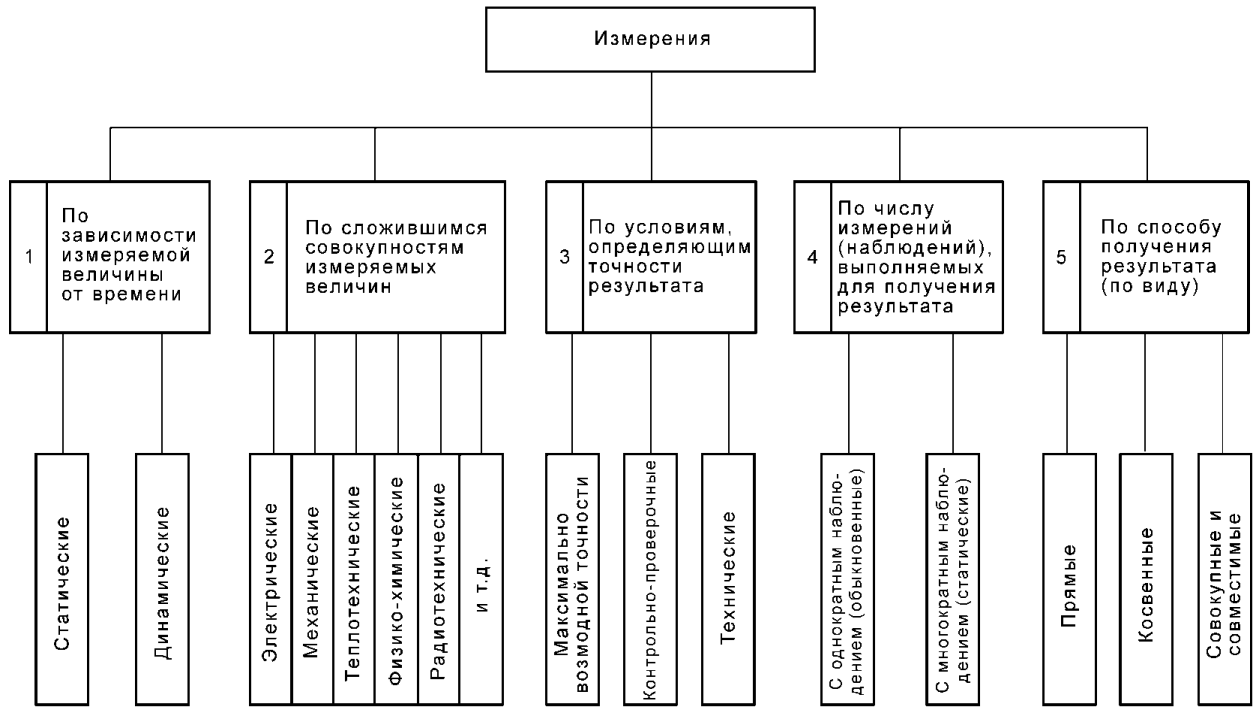
Рисунок 1 – Классификация средств измерения
