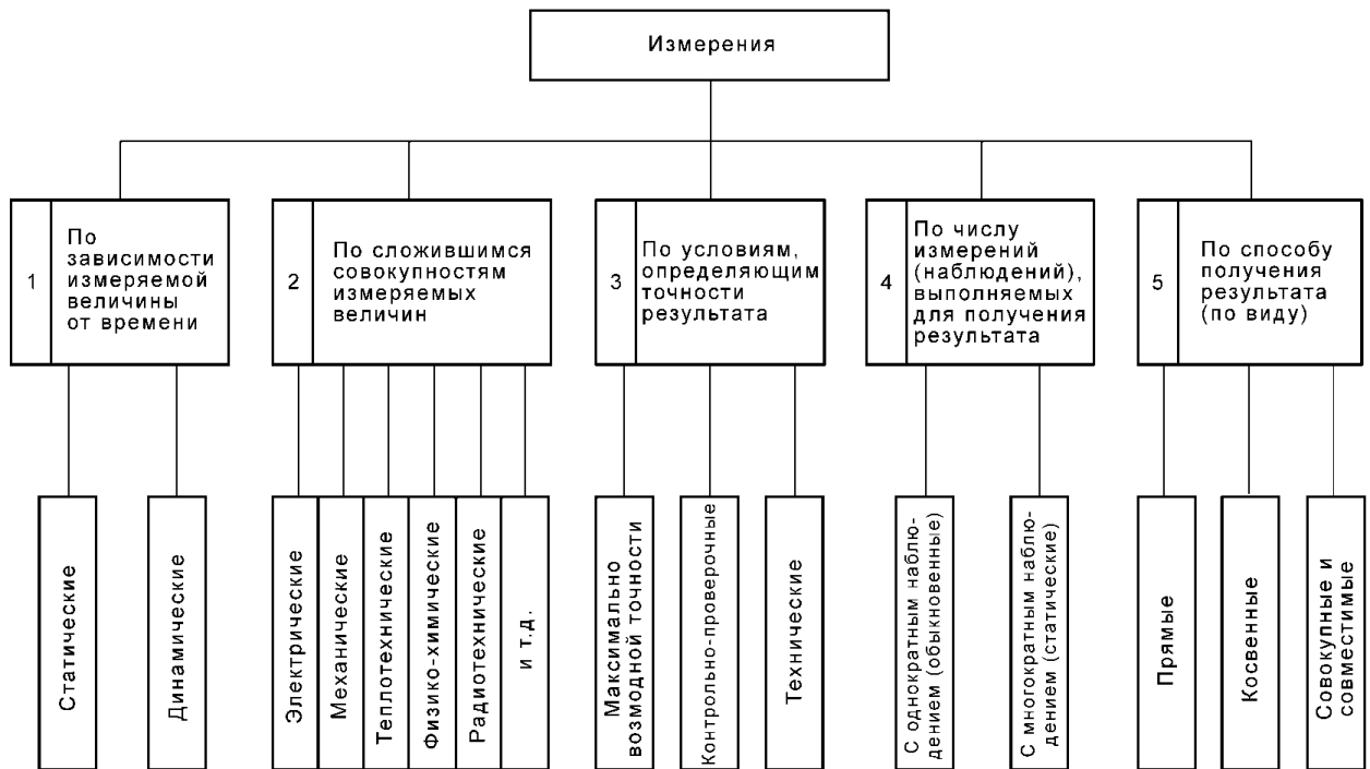
Рисунок 1 – Классификация средств измерения
